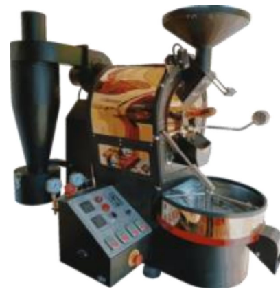
Gambar 4 Mesin Sangrai Kopi SAS R2 V-6
